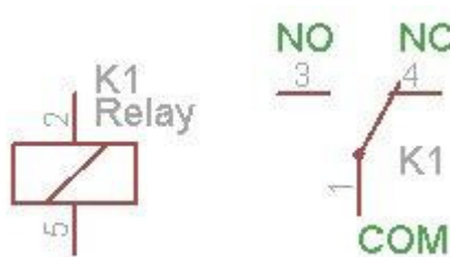
Figur 3 Diagramsymbol for et relæ
